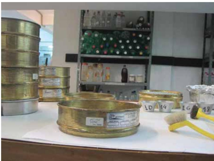
Figura B.4: Separação do sedimento retido em cada peneira, após 15 minutos no vibrador.
