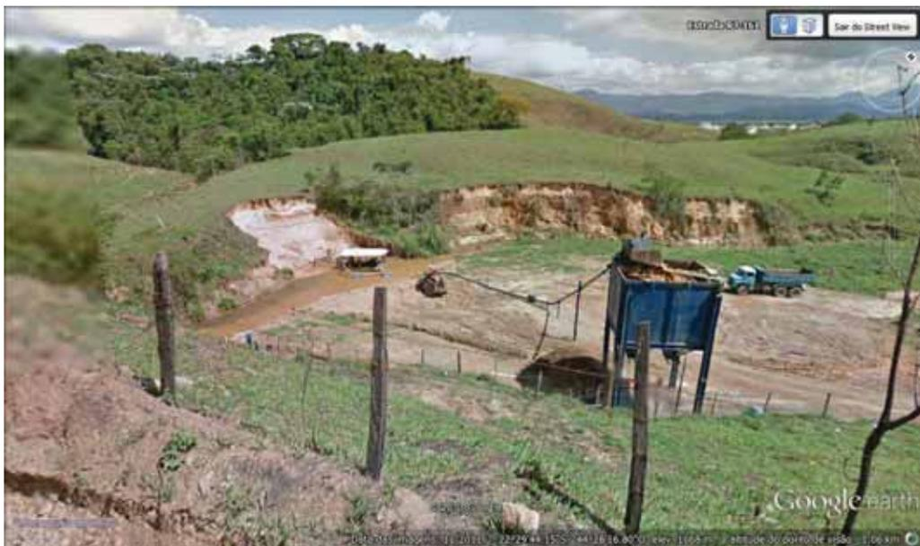
Figura C.44: Retirada de areia das margens do rio, iniciando um grave processo de erosão. Fonte: Google Earth.
