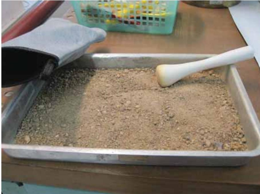
Figura B.1: Destorroamento da amostra após secagem em estufa.
