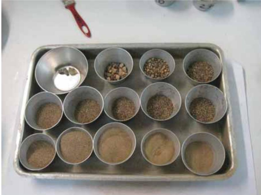
**Figura B.7: Separação dos sedimentos por peneira para serem pesados.**
