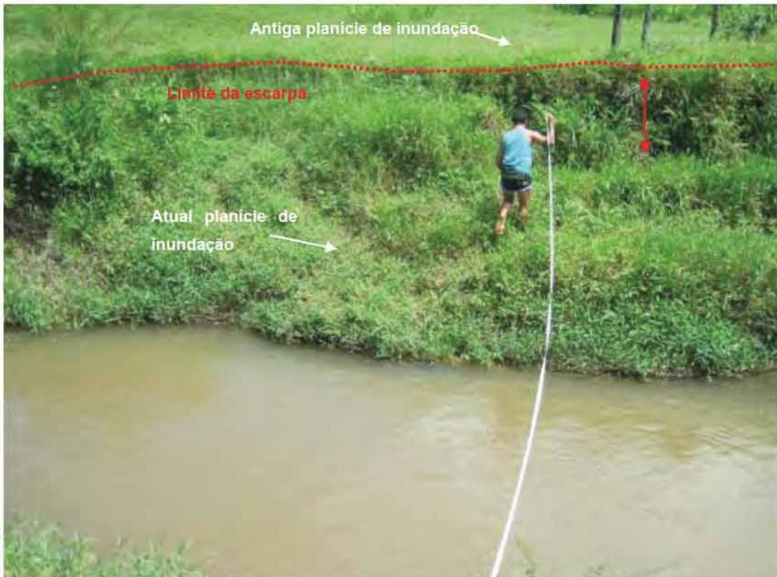
Figura C.137: Foto do trecho 15, mostrando as planícies atual e anterior e a escarpa de erosão.
