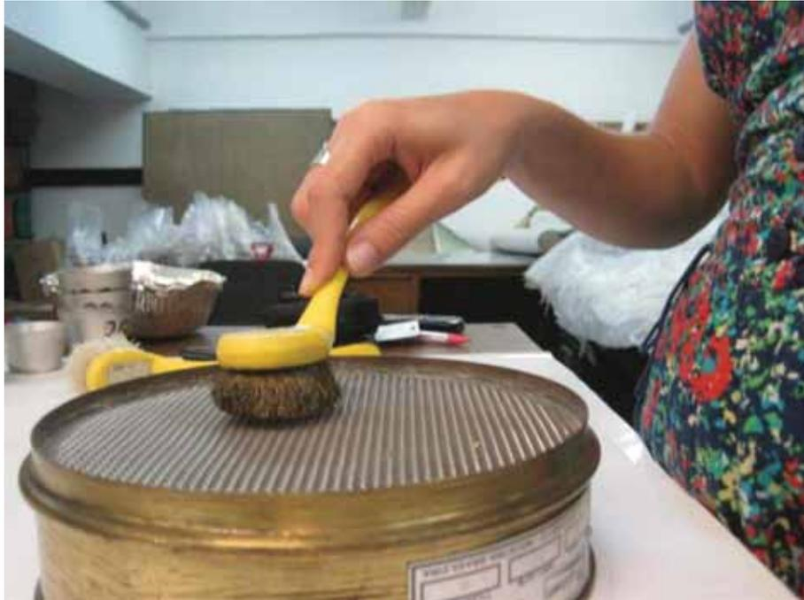
**Figura B.5: Retirada de todos os sedimentos retidos na peneira.**
