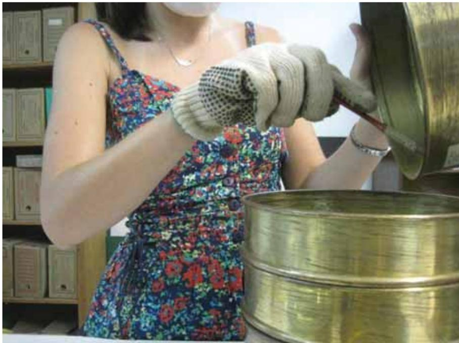
**Figura B.6: Retirada dos sedimentos retidos no prato para colocação do jogo de peneiras seguinte no vibrador.**
